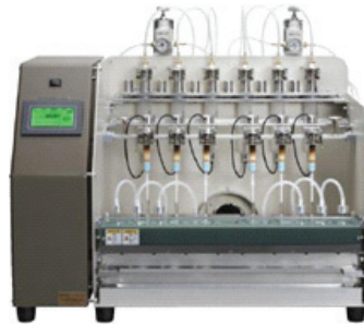
絶縁油中の微量PCB測定 専用の前処理装置
