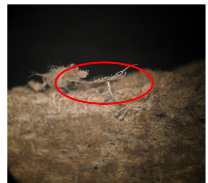
写真. 建材中のクリソタイル
