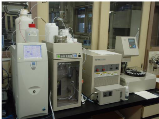
自動試料燃焼ーイオンクロマトグラフ装置
