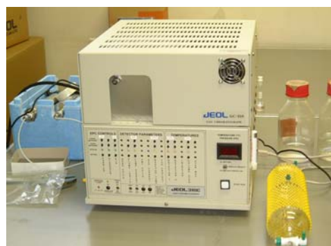
GC-PID による現場簡易分析 (即日分析)
