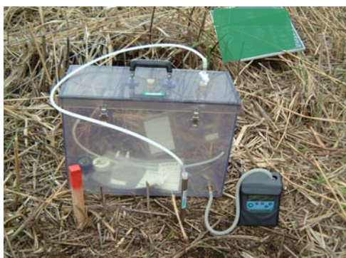
土壌ガスサンプリング
